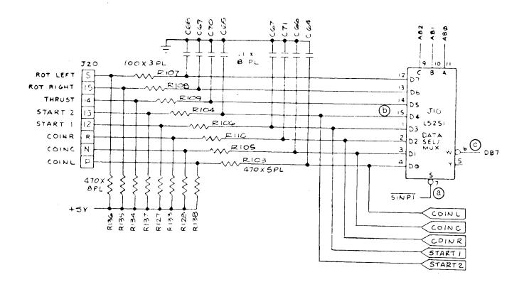
Figure 6.4 Switch Inputs (Asteroids Deluxe<sup>TM</sup>)
